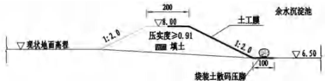
图 4.4-1 余水沉淀池围堰典型断面图
